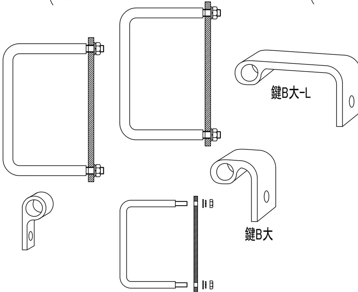
外して鍵を通し、柱の穴に取付ける
